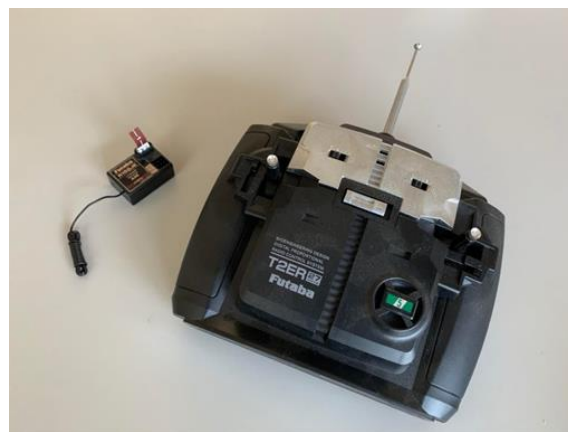
市售 3 通道 27MHz 板型遙控收發器
